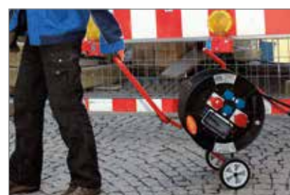
Trommelkörper in Fahrtrichtung
